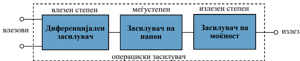
Слика 6.5: а) Блок-шема на операциски засилувач 741
