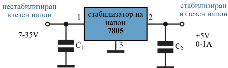
Слика 9.25: Приклучување на интегриран стабилизатор на напон
