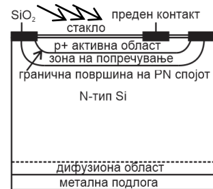
Слика 2.18: Пресек на фотодиода
